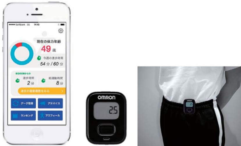
図3. 新携帯型カロリー計 (i-Walk Pro ® ) 3軸の加速度計と気圧計を搭載し、それぞれで測定した運動エネルギーと位置エネルギーの和から総エネルギー消費量を測定できる。原理は従来型と同じだが(文献5)参照), 携帯端末対応になったのと, 小型軽量で値段が安くなったのが特徴。詳細は, NPO 法人 熟年体育大学リサーチセンター ( http://www.jtrc.or.jp ) まで。
